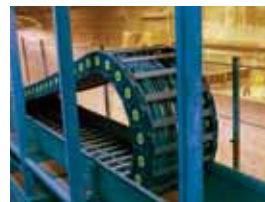
Energieführungskette aus Kunststoff vom Typ MSO, Einsatz in der Müllverbrennungsanlage "Vestforbrænding" in Dänemark
