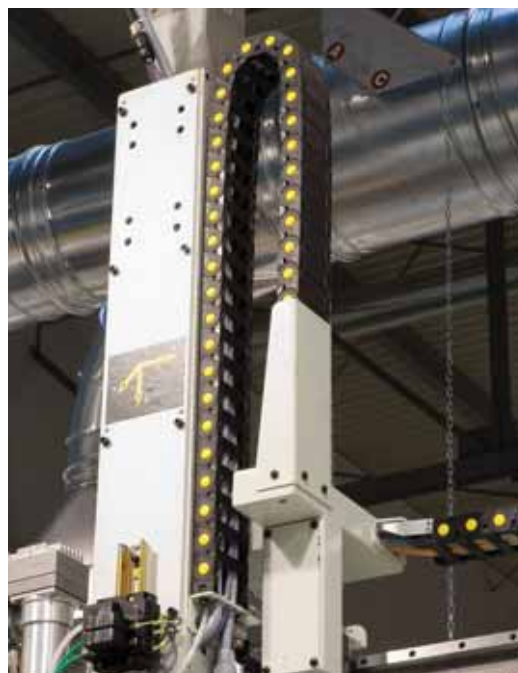
Vertikaler Einsatz von Energieführungsketten aus Kunststoff
